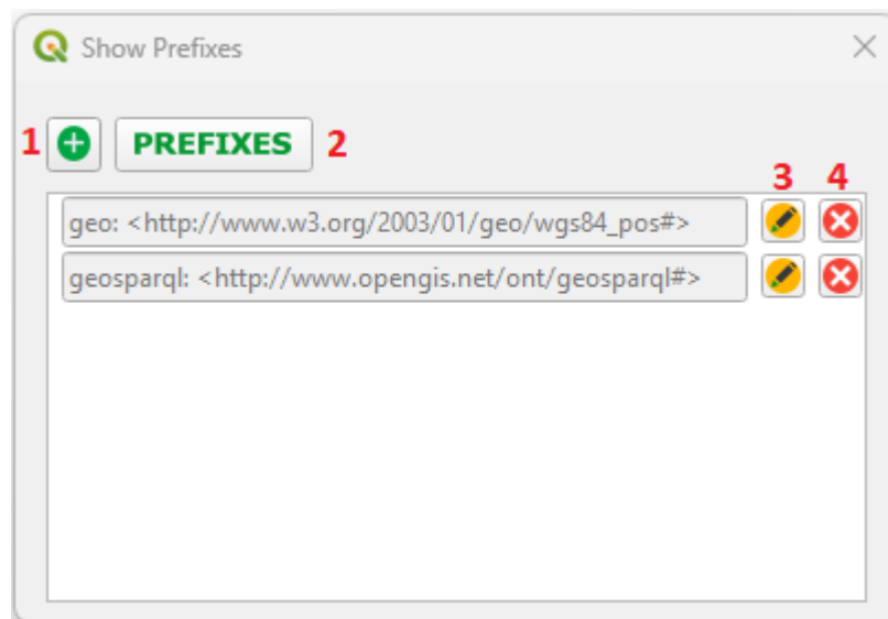
Rys. 4. Okno do edycji prefiksów połączenia. 1 – dodanie nowego prefiksu, 2 – lista unikalnych prefiksów wszystkich połączeń, 3 – edycja prefiksu, 4 – usuwanie prefiksu.
