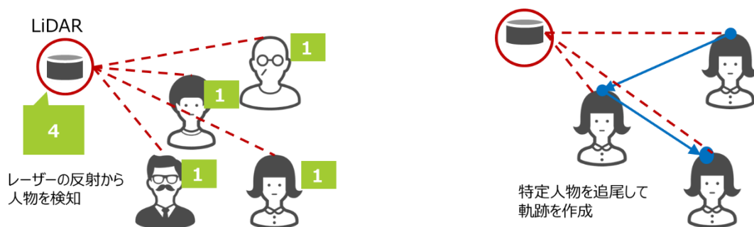
図 5 LiDAR によるカウントデータ(左)と軌跡データ(右)の取得イメージ
