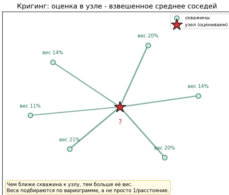
Рис. 3: Кригинг оценивает значение в узле как взвешенное среднее ближайших скважин: чем ближе скважина, тем больше её вес. Веса подбираются по вариограмме.
