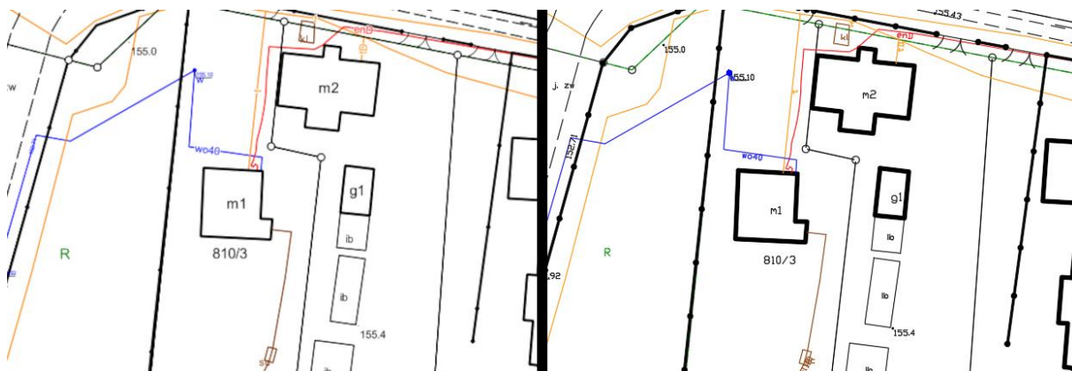
Rys. 8. Widok mapy wygenerowanej z pliku GML. Po lewo widok QGIS, po prawo DXF.
