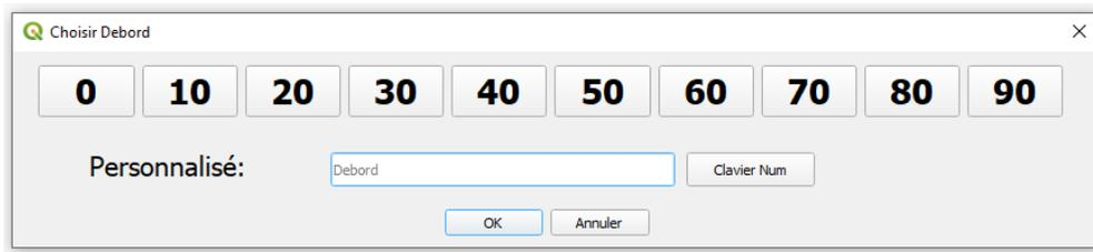
L'utilisateur peut choisir un débord de toit dont la cote est déjà définie en cliquant sur l'un des boutons (0, 10, 20, etc.). Il peut également rentrer sa propre cote dans le champ de texte. Il doit ensuite cliquer une fois à l'endroit où il veut placer le débord de toit.
